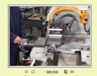
Чистовое точение цилиндра на токарно-винторезном станке.
